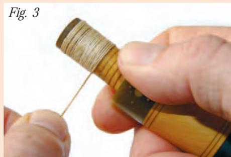
Terminez par un nœud simple : maintenez votre enroulement avec le pouce, formez une dernière boucle lâche, passez l'extrémité du fil dans cette boucle pour former un nœud, qu'il vous reste à serrer pour achever la ligature (4).
