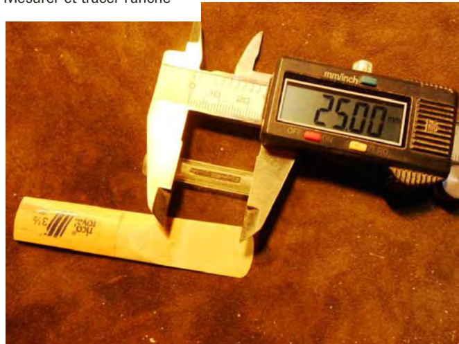
Amincir le roseau jusqu'à amener la lamelle a la bonne largeur
